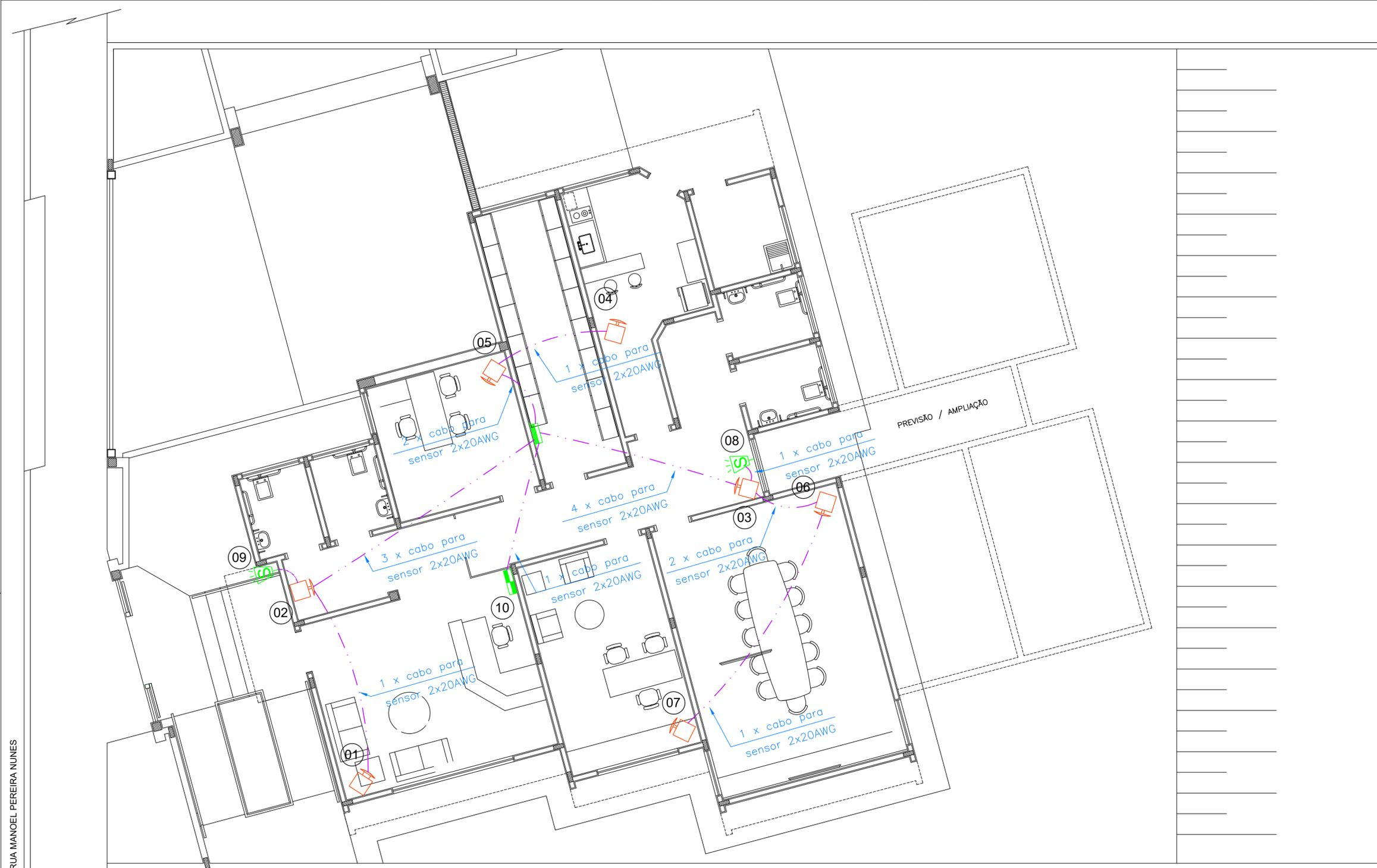
PLANTA BAIXA - INSTALAÇÕES DE CABEAMENTO ESTRUTURA E CFTV
