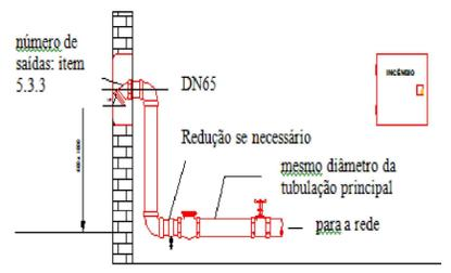
**REGISTRO DE RECALQUE - TIPO COLUNA SEM ESCALA**
