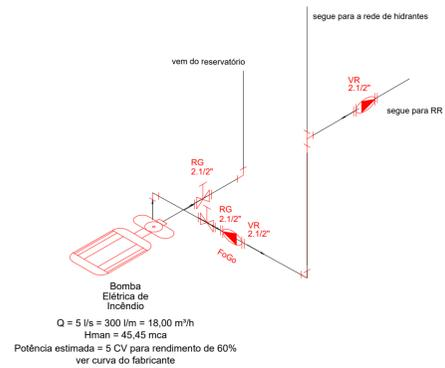
**ISOMÉTRICO BOMBA HIDRÁULICA**
