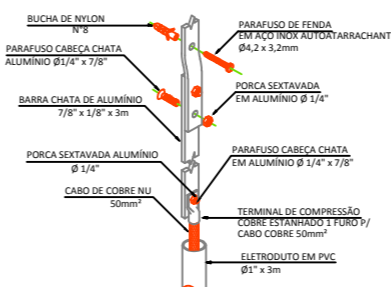
DETALHE DE FIXAÇÃO DE BARRA CHATA DE ALUMÍNIO E DERIVAÇÃO PARA CABO DE COBRE COM PROTEÇÃO ATRAVÉS DO ELETRODUTO DETALHE 3 SEM ESCALA
